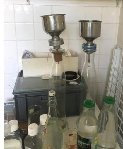
Figure 13: filtration "Milipore" des échantillons
