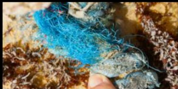
Voici la source des fibres cylindriques trouvées systématiquement dans les prélèvements d'eau de mer. Les cordages en polypropylène se dégradent en microfibrilles facilement identifiables en raison de leur forme cylindrique, de leur diamètre relativement gros par rapport aux fibres textiles, et par leur couleur généralement bleue, parfois verte et plus rarement rouge.
